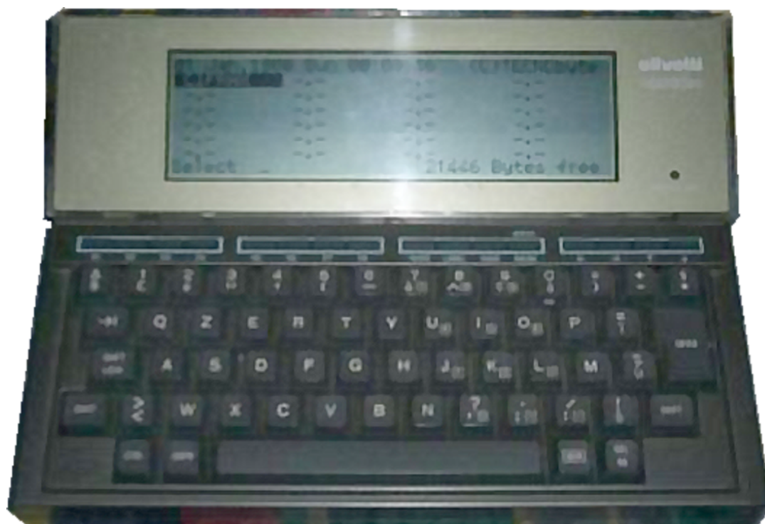
Figura 14.19. Tastiera QZERTY dell'elaboratore portatile Olivetti M10, anno 1983. L'immagine è stata ottenuta da un'asta telematica di apparecchiature usate.
