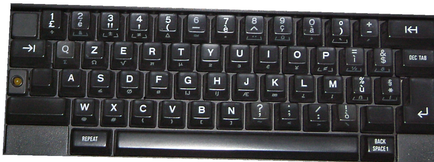
Figura 14.22. Dettaglio della tastiera della macchina da scrivere elettronica Olivetti ET116.
