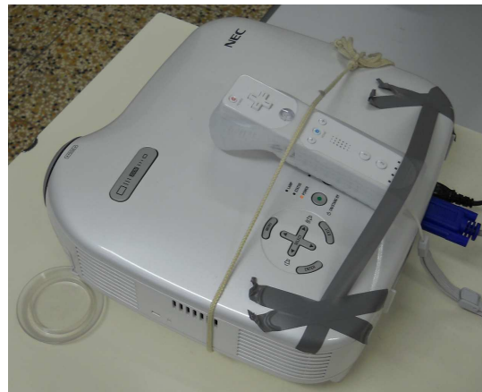
Figura 60.19. Fissaggio di fortuna del Wiimote sul proiettore.
