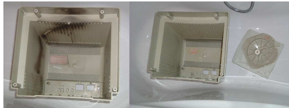
Figura 9.129. Lavaggio del coperchio posteriore di un monitor, con l'aiuto di una doccia. Sulla sinistra si vede la sporcizia maggiore accumulata in corrispondenza del cavo di alta tensione.
