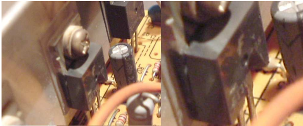
Figura 9.6. Fusibile. In questo caso, il fusibile è saldato e non può essere sostituito facilmente.
