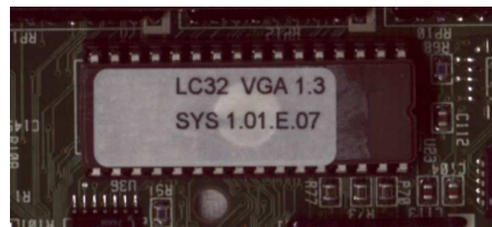
Figura 9.73. Memoria «flash» degli anni 1990, riprogrammabile senza bisogno di estrarre l'integrato dalla scheda madre.
