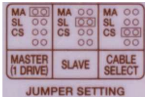
Figura 9.24. Un'etichetta che appare su un disco fisso per guidare la configurazione in qualità di master o di slave , oppure lasciando che sia il cavo a definire la posizione.
