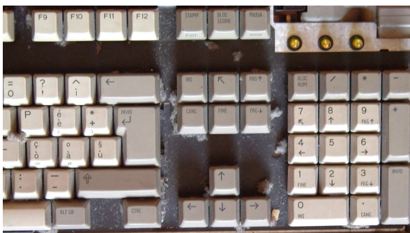
Figura 9.135. Una tastiera Olivetti degli anni 1990, prima della pulizia, dopo l'estrazione di tutti i tasti. Viene messo in evidenza quanta sporcizia si accumuli sotto i tasti.
