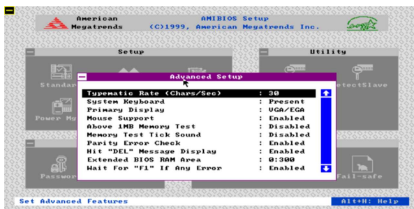
Figura 9.97. Programma di configurazione di un BIOS AMI con menù grafico: menù avanzato. 2
