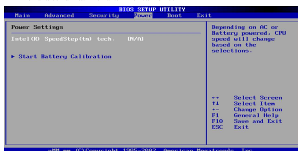
Figura 9.93. Programma di configurazione di un BIOS AMI con menù a tendina: menù alimentazione. 2
