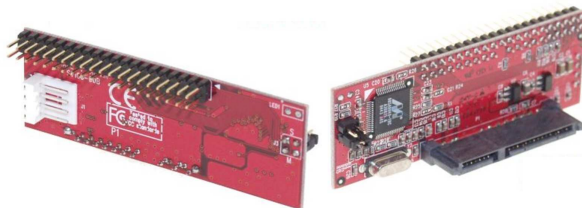
Figura 9.45. Adattatore da bus SATA a disco PATA. Questo adattatore si applica al disco PATA.
